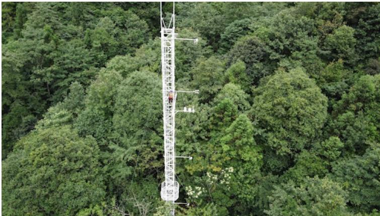
通量塔及通量塔测量网络是测量通量的必须，也是生态系统生态学的学生在课程中、学者在研究中要么实地探访，要么下载相关数据分析而一定会接触到的生态学方法。Source: 中国通量观测研究联盟 chinaflux
